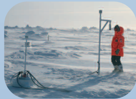
Installation du système IMB pour mesurer l'épaisseur de la glace et ses variations au cours du temps, ainsi que les profils verticaux de température à travers la glace. © Francis Latreille/Tara-Arctic
