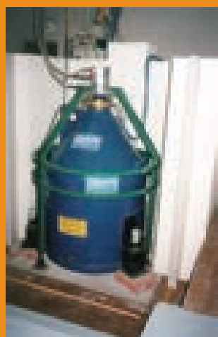
8. Gravimètre supraconducteur GWR.
