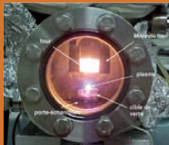
9. Expérience de condensation à haute température d'un gaz de composition solaire, CRPG CNRS-INSU Nancy.
