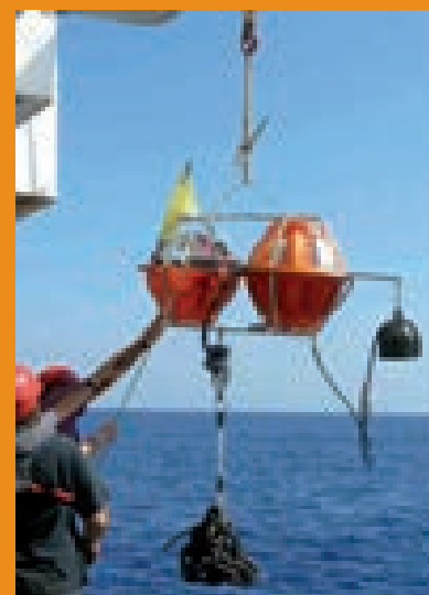
14. Mise en place d'une station « fond de mer ».
