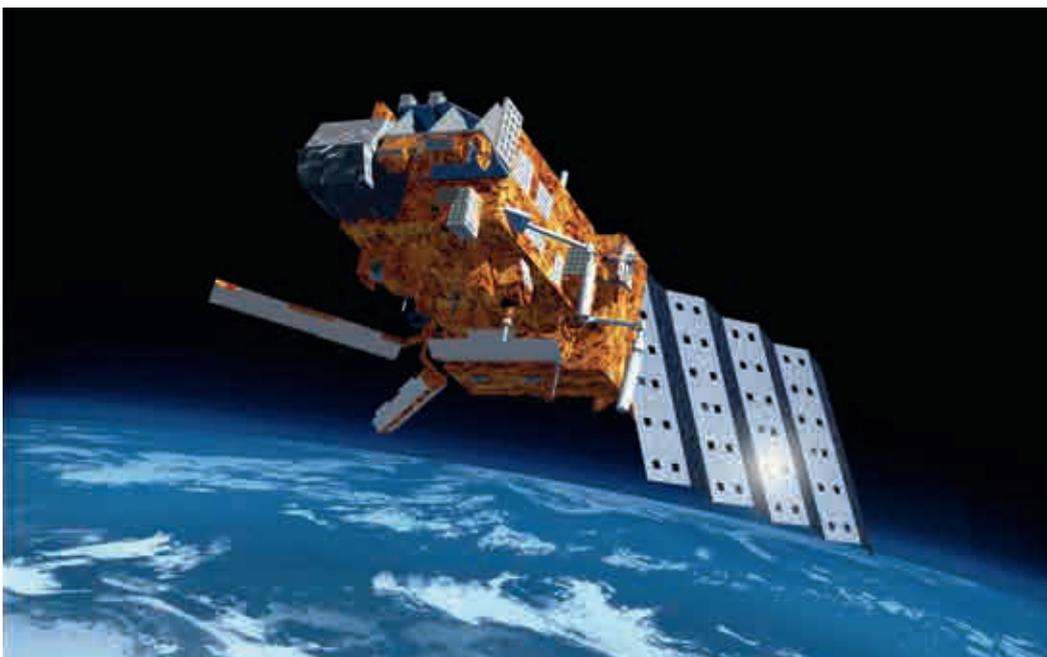
L'interféromètre infrarouge IASI embarqué sur le satellite METOP mesure en continu depuis 2006 une vingtaine de paramètres atmosphériques dont les profils de température et d'humidité, la distribution des nuages, des concentrations d'aérosols, de gaz à effet de serre ( $CO_2$  et  $CH_4$ ), d'ozone ( $O_3$ ), de monoxyde de carbone (CO), d'ammoniac et de dioxyde de soufre ( $SO_2$ ), et des caractéristiques de surface (émissivité, température). © CNES
