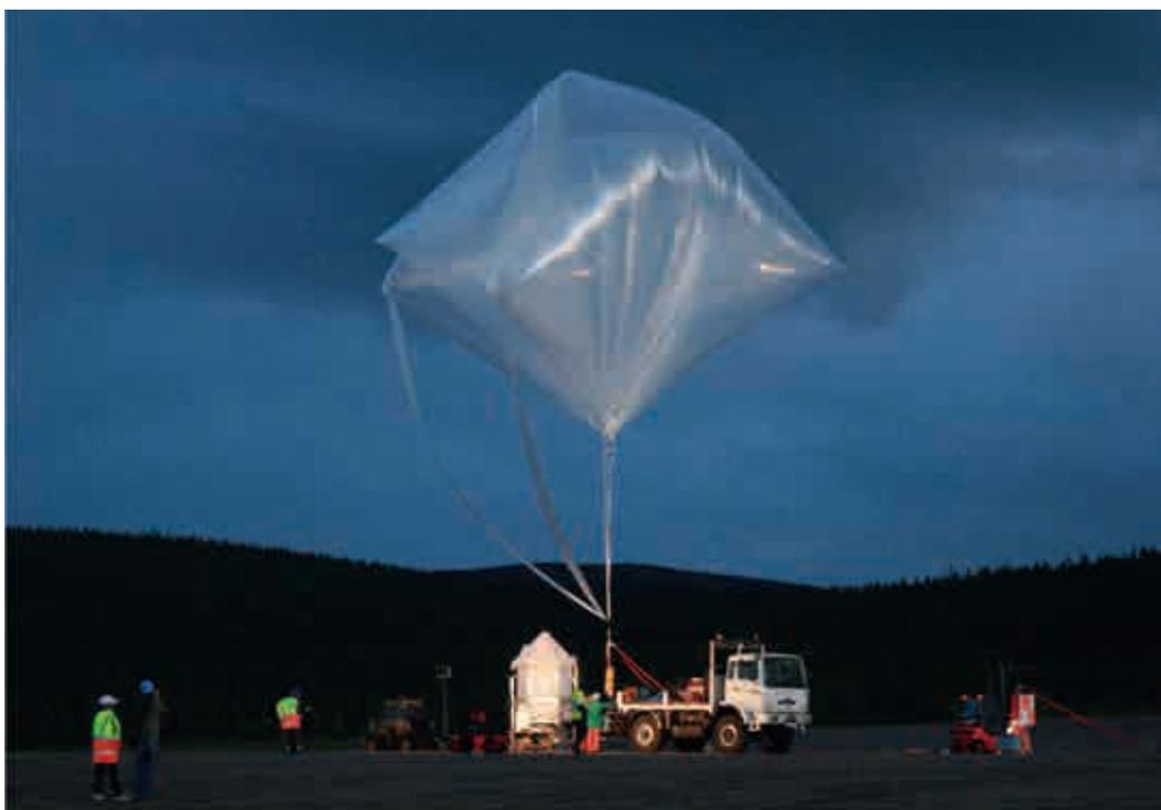
*Les nouveaux outils embarqués sous ballon ont permis de mieux appréhender le rôle de la stratosphère dans la dynamique du climat. Ainsi, le projet STRAPOLETÉ a permis de procéder à l'étude des processus de transport et d'échantillonner les contenus en aérosols et composés halogénés dans la stratosphère arctique durant l'été. © CNRS/LATMOS*
