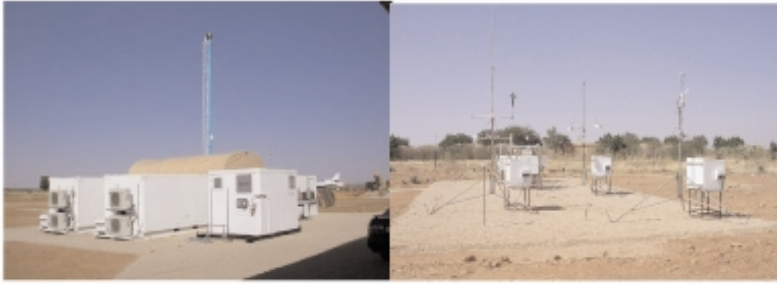
Esemble de mesures in situ et de télédétection (lidar, radiomètre) station ARM (US), Mesure des flux et rayonnement , station ARM (US) © AMMA
