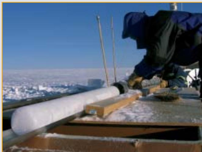
**Station Summit, Groenland Central (National Science Foundation). Une section de carotte est ramenée à la surface lors du forage 100 mètres. Etude de la fonction de transfert du mercure gazeux de l'atmosphère à la transition névé-glace. Détermination de la composition atmosphérique passée en mercure gazeux sur les 30 dernières années. © CNRS Photothèque, Photographe : FAIN, Xavier**
