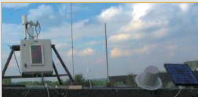
*Photomètre solaire du Sirta © CNRS*
