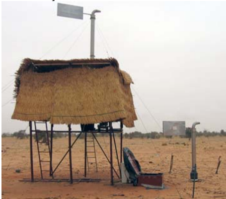
Amma, site de prélèvement et d'analyse des aérosols mis en œuvre par le Lisa près de Niamey (Niger). © Amma, CNRS
