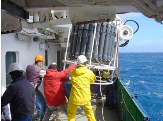
Ensemble de bouteilles pour le prélèvement d'eau à différentes profondeurs pendant la mission Keops. © CNRS Photothèque / Keops
