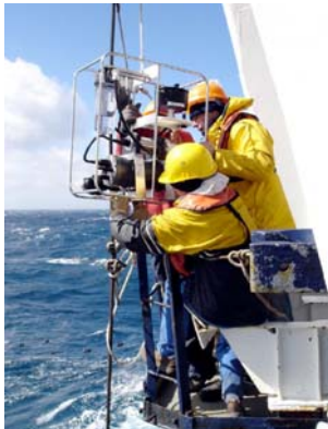
Installation d'une pompe à particules immergeable sur le câble du Marion Dufresne. © KEOPS / CNRS 2007.
