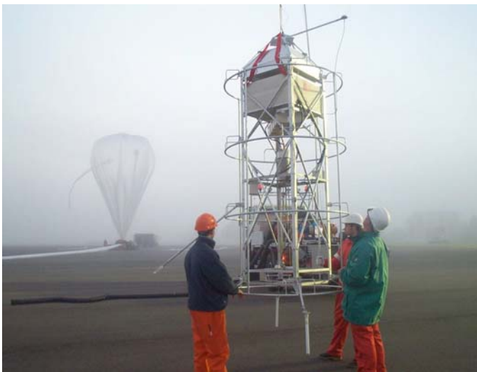
Décollage sous ballon stratosphérique d'un instrument d'analyse in situ . © CNRS
