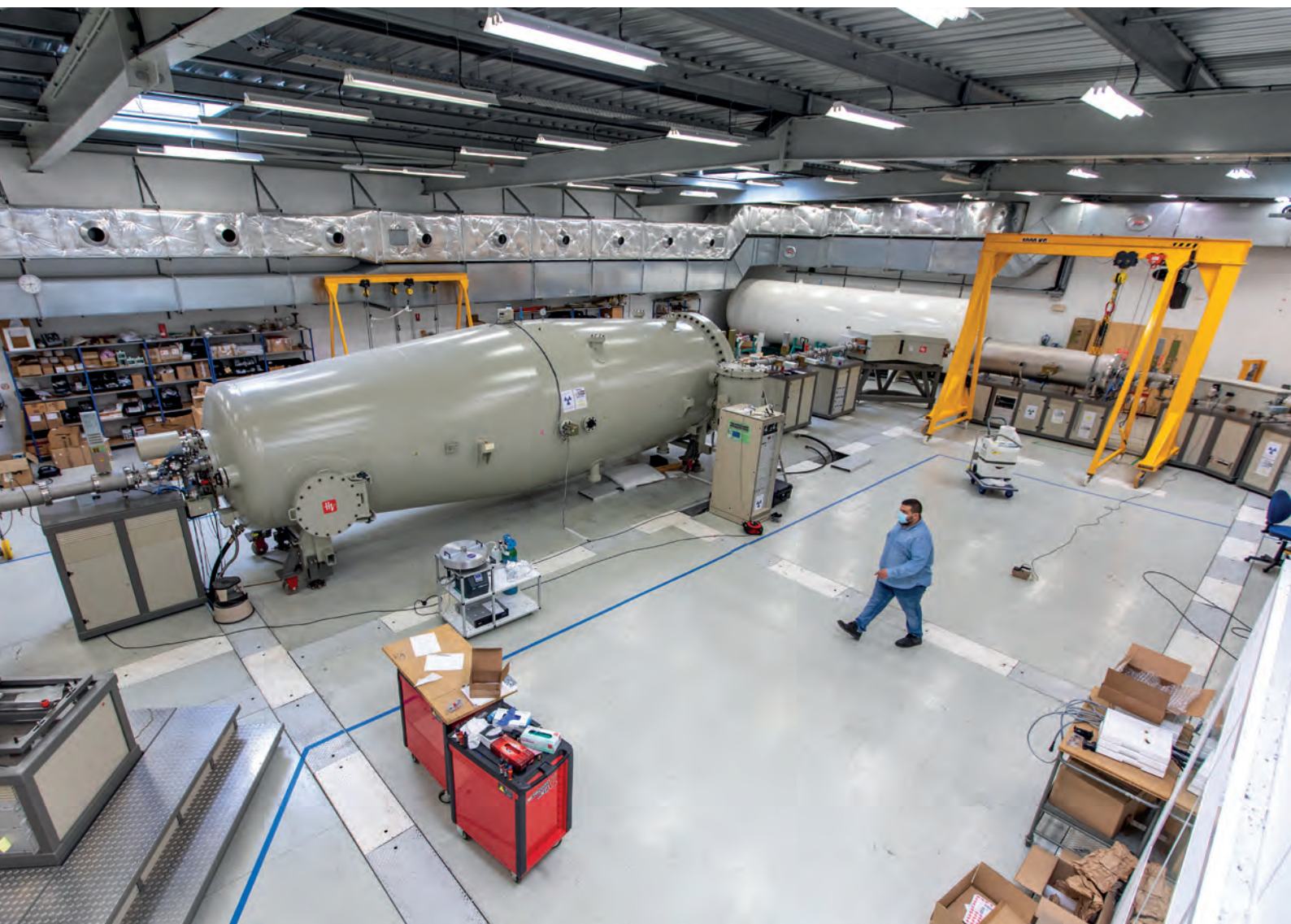
B 2.1.2 – Spectromètre de masse par accélérateur ASTER, sur le site du CEREGE © Thibaut VERGOZ / CEREGE / CNRS Images
