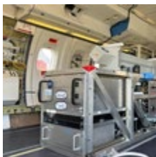
A2S2 : nouvel instrument aéroporté pour mesurer le profil atmosphérique vertical d'absorption par les aérosols
